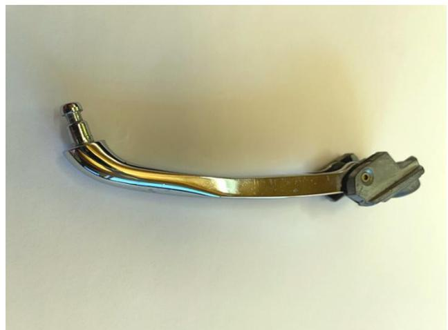
2. Den abgebrochene Kurbelhebel vorsichtig aus der Montagekonsole herausnehmen. Danach die beiden schwarzen Plättchen links und rechts neben dem Montagekonsole ausbauen.
