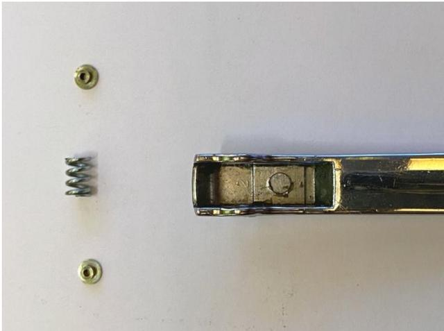
4. Die vorhandene Bohrung an der linken Seite der Montagekonsole aufbohren mit Bohrer D = 4,0 mm und mit Bohrer D = 6mm senken. !!!Bohrung auf der Innenseite unbedingt entgraten!!!
